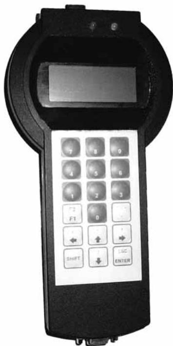
Терминал-накопитель переносной предназначен для считывания и переноса архивных данных со счетчиков газа "Гобой-1" на персональный компьютер. Питание прибора осуществляется от автономного источника постоянного тока на номинальное напряжение 6 В (четыре батареи типа LR6). Потребляемая мощность не более 0,5 В·А. Замена элементов питания производится без разбора корпуса прибора.
