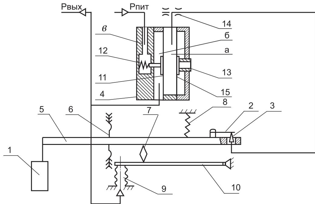
1 - элемент чувствительный (буек); 2 - заслонка; 3 - сопло; 4 - пневмоусилитель;
